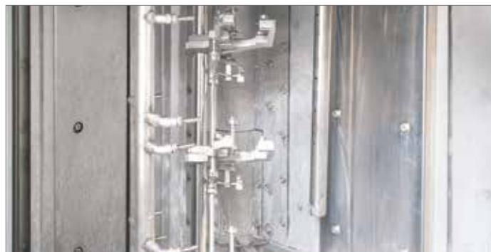
Vista en la zona de secado: Secado con sistema rotatorio de boquillas y potente compactador de canal lateral
